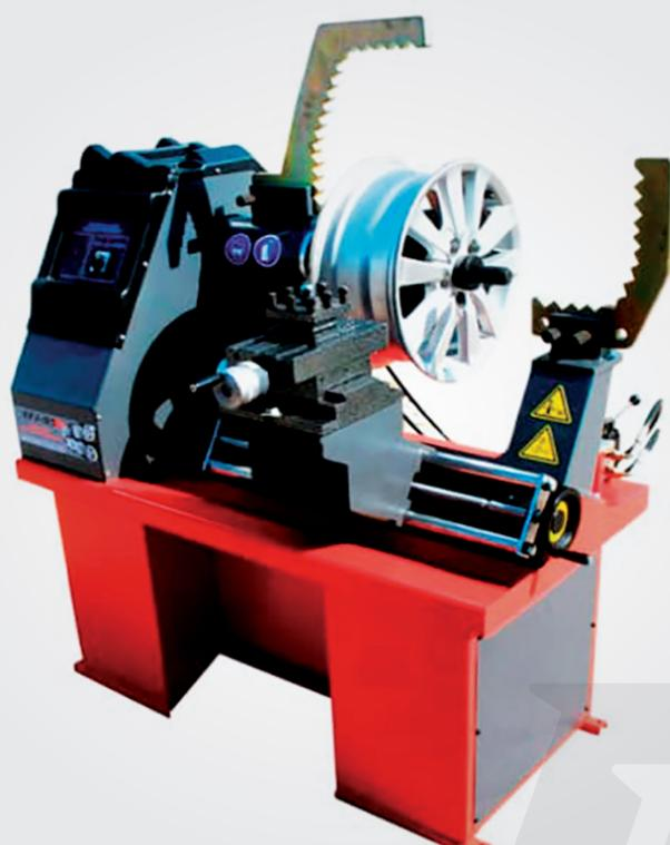
Nuestra enderezadora de aros está proyectada y realizada para realizar el trabajo de enderezar cualquier tipo de aro / rin / llanta en acero, aluminio y aleacion, una amplia gama de punzones que se apoyan perfectamente a los diferentes perfiles del aro.
