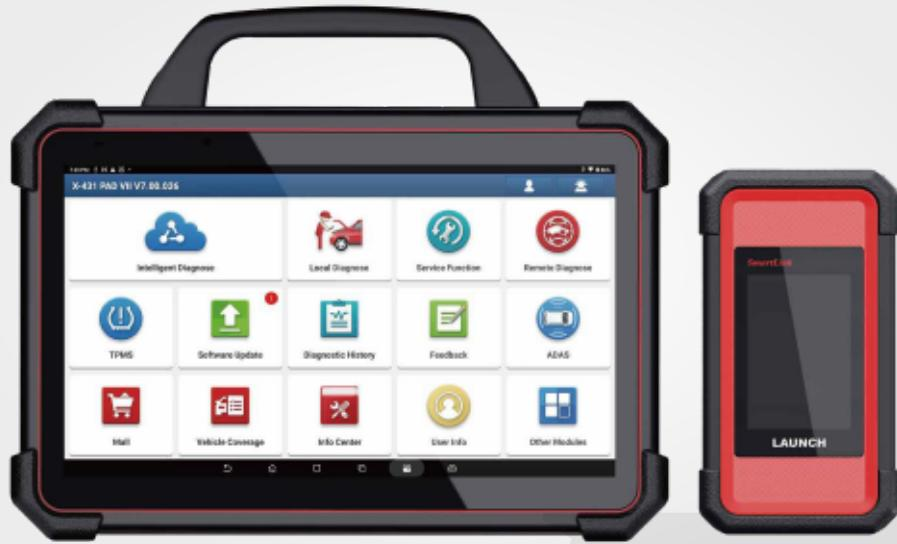
El X-431 PAD VII Link es una herramienta de diagnóstico de gama alta de LAUNCH, que viene con funciones de calibración ADAS, 39 funciones de servicio, servicios TPMS y otras funciones de módulos extendidos.
