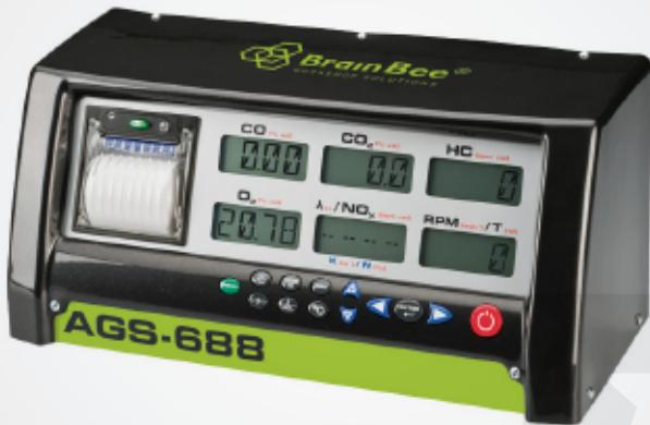
El analizador de gas AGS-688 puede funcionar en modo estático y dinámico, al tomar muestras de las emisiones en el tubo de escape con la sonda suministrada, diseñada para este fin.
